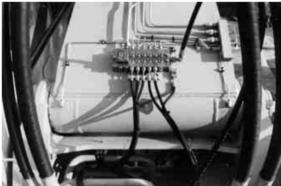
figuur 4.4 Vetverdeler met leidingen die naar vetnippels lopen
