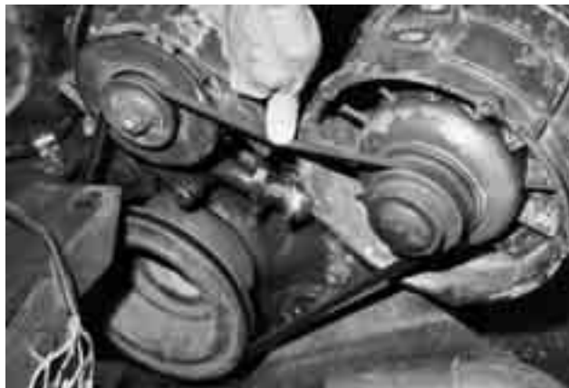
figuur 2.33 Het controleren van de V-snaarspanning
