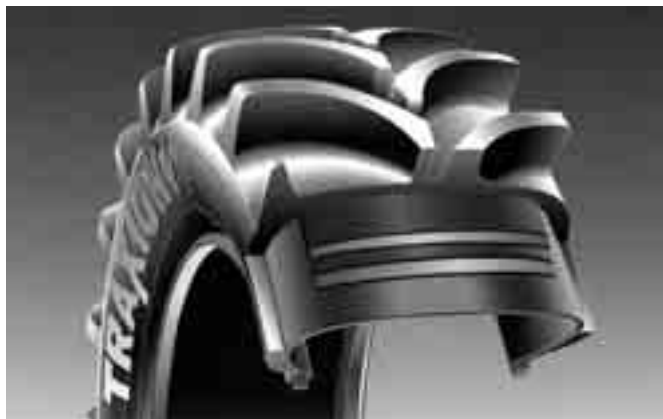
figuur 2.15 De opbouw (het karkas) van een trekkerachterband
