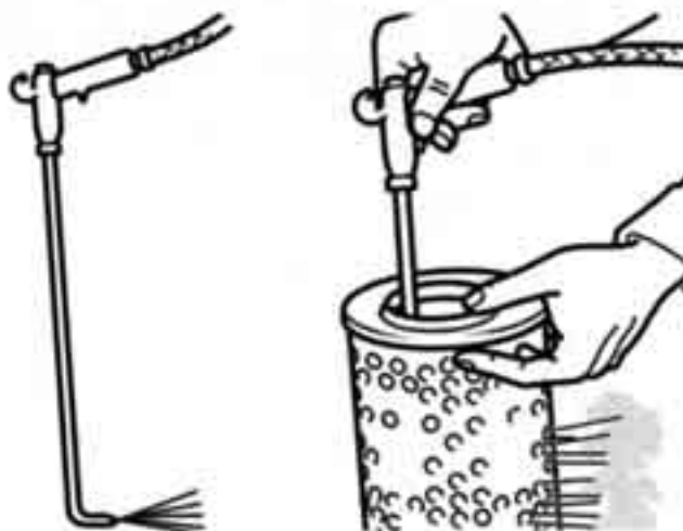
figuur 1.8 Met perslucht kun je het filter schoonblazen.
