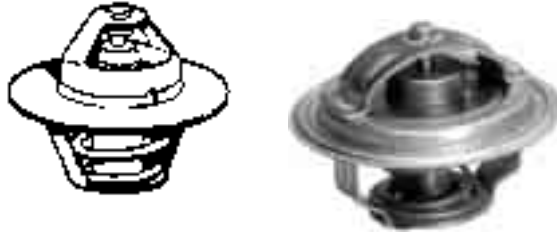
figuur 1.23 De motor is snel op temperatuur door een thermostaat.
