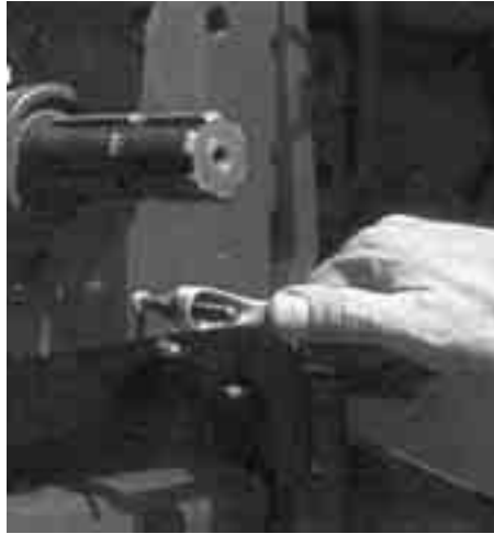
figuur 3.45 Ook met een tapeindset kun je een boutrest verwijderen.
