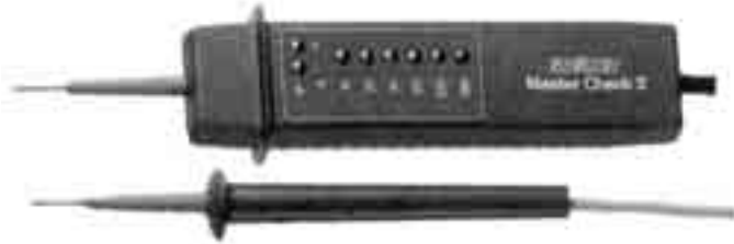
figuur 2.10 Met een spanningsmeter kun je spanning meten van 6 tot 400 Volt.
