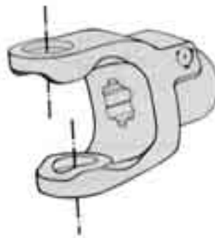
figuur 2.80 Een gaffelbeen is verdraaid.
