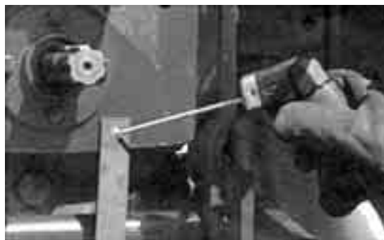
figuur 3.42 Een stripje ijzer biedt houvast om de boutstomp los te draaien.
