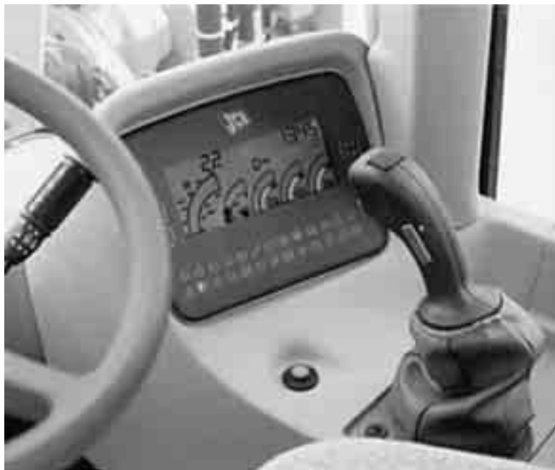
figuur 4.7 Een cabine van een wiellader, met veel elektronica, kun je beter niet uitspuiten met water.
