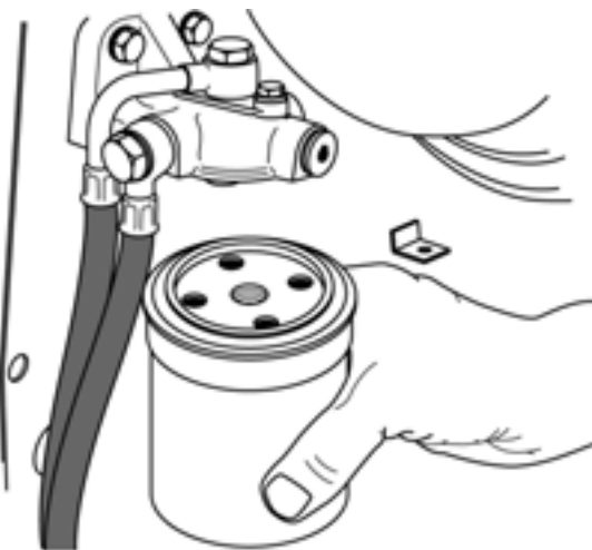
figuur 1.14 Bij een grote onderhoudsbeurt vervang je het filterelement.
