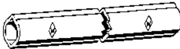
figuur 2.48 Een tussenas bestaat uit twee in elkaar schuivende profielbuizen.
