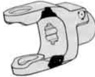
figuur 2.81 Een gaffelbeen is beschadigd.
