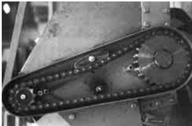
figuur 2.41 De kettingspanner moet per se in het losse gedeelte staan!
