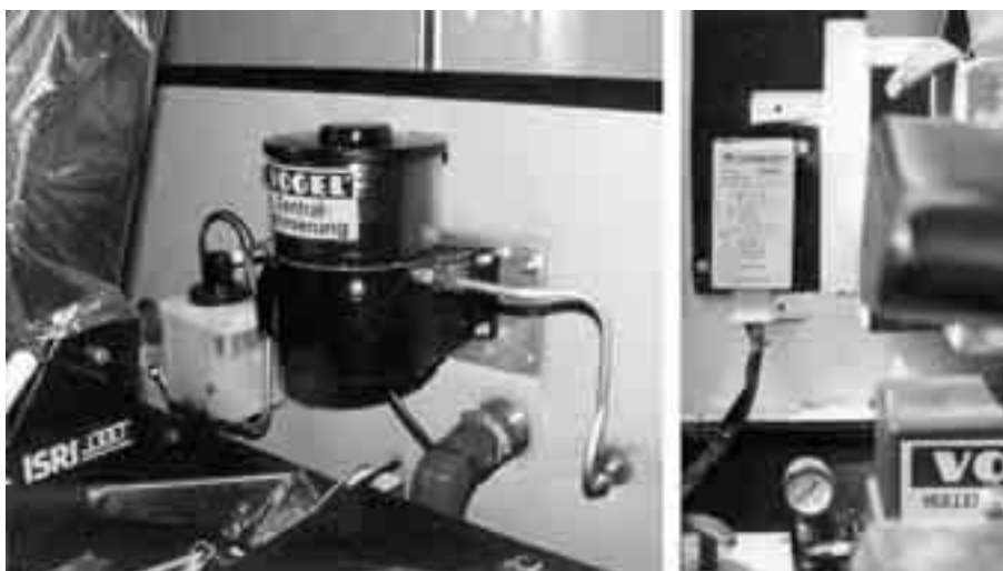
figuur 4.3 Bij het volautomatische smeersysteem wordt het vet door dunne leidingen naar de vetnippels gepompt.
