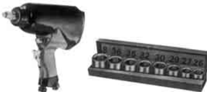
figuur 3.16 De doppen van een slagmoersleutel zijn altijd zeskantig.
