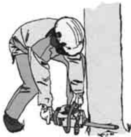
figuur 1.35 Een motorkettingzaag staat zelden vlak.
