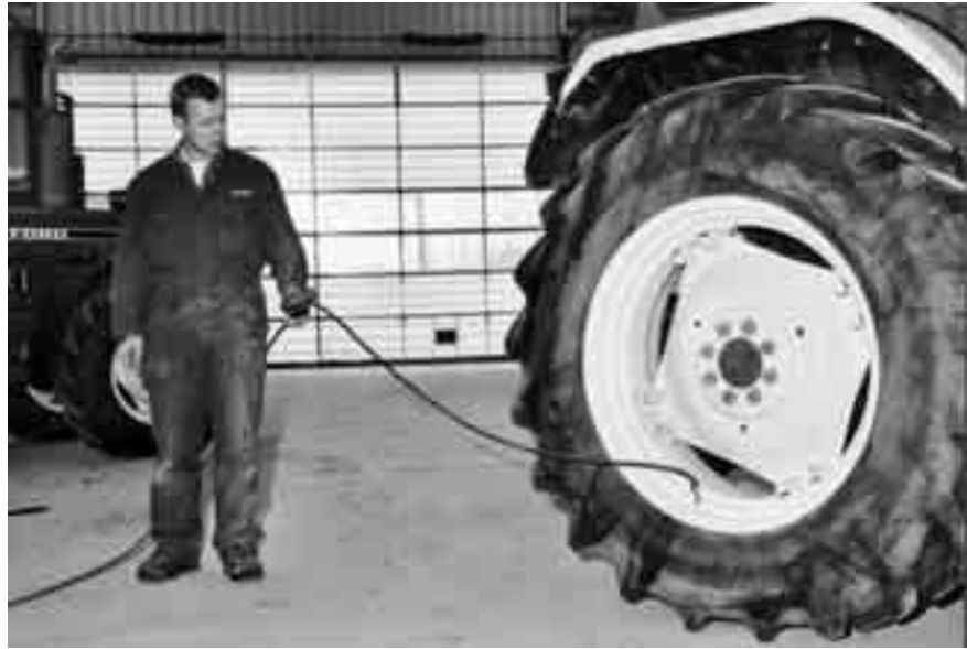
figuur 2.13 Zo pomp je een luchtband op met een banddrukregelaar.
