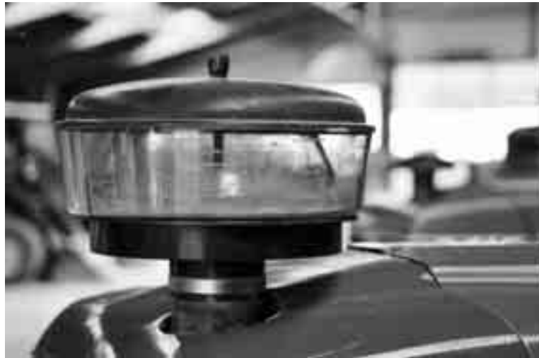
figuur 1.7 Als je werkt onder stoffige omstandigheden plaats je vaak een cycloonvoorfilter.
